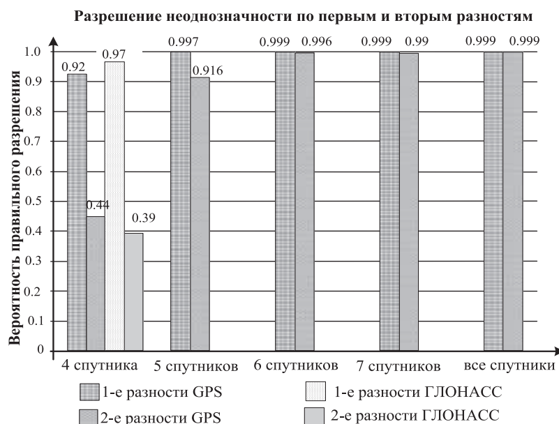
Рис. 12. Вероятность правильного разрешения неоднозначности несмещенных первых и вторых разностей псевдофаз в зависимости от числа КА в зоне видимости
